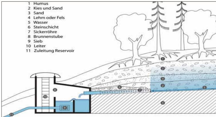
Schematische Darstellung der Quellwasserfassung mit einer Brunnenstube.
