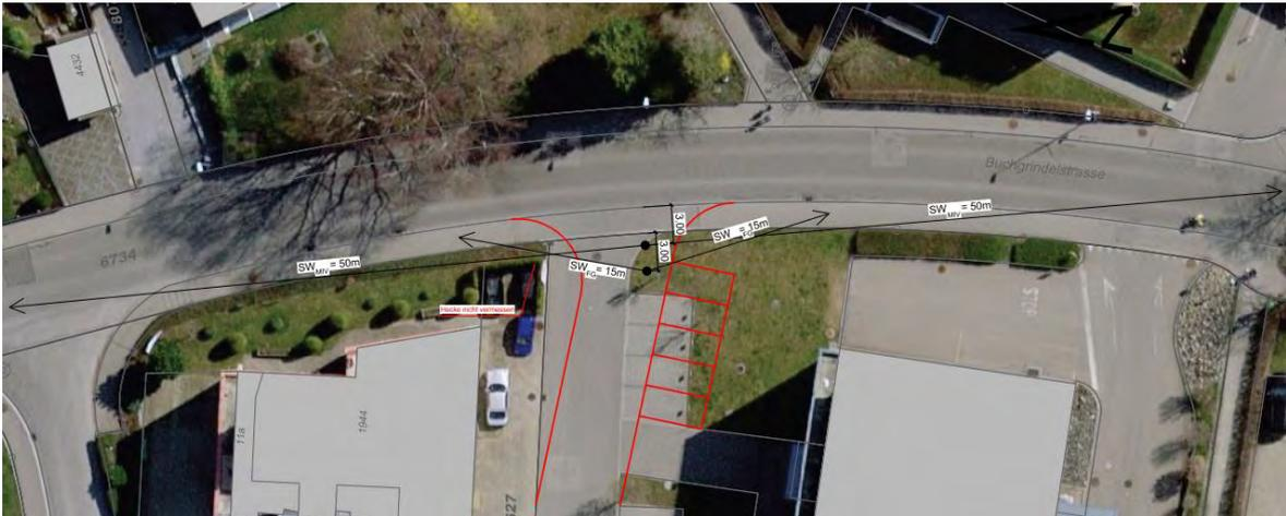
Abbildung 4: Situation Einmündung 3 mit Sichtweiten
