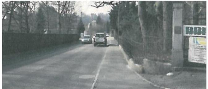
*Bei einer künftigen Sanierung des unteren Teils der Usterstrasse müsste aus Sicherheitsgründen der Strassenquerschnitt von 13 Metern weitergeführt werden. Aus Platzgründen wird dies jedoch nicht möglich sein.*
