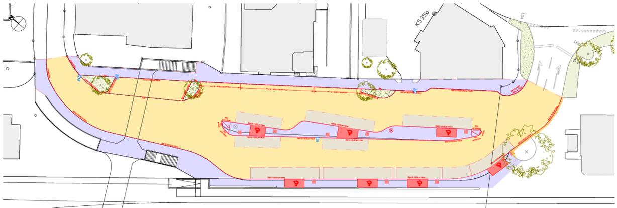
Es ist vorgesehen, den heute gepflasterten Bereich aufzuheben und in Belag auszuführen (Lärm, Kosten). Die Busplatten werden in Beton ausgeführt. Die Haltekannten werden auf das behindertengerechte Mass angehoben und ebenfalls in Belag ausgeführt. Die Haltekannten werden mit taktilen Linien markiert.
